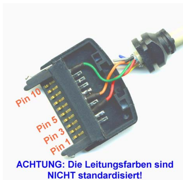
Abb. 2: Kontaktbelegung am PDA-Stecker
